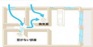
部屋のドアを開けて、扇風機などを置いて部屋の外に空気が流れるようにする
