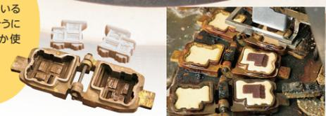
店舗2階にある専用の機械。もみじ饅頭の機械と同じ構造だそうです
