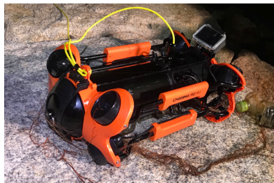
図2. 主に撮影で使用了水中ドローン(CHASING M2 PRO)．本体サイズは480×267×165 mm，重量は5.7 kg.
