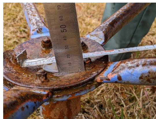
事故の原因となったボルト
