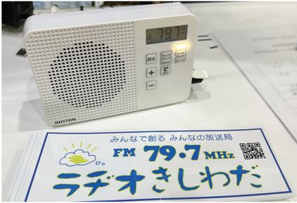
防災専用ラジオは、緊急時にコミュニティラジオ局「ラヂオきしわだ」が遠隔で電源を入れ、放送を流します。クラウドファンディングで調達した資金で購入し、希望者に無料で配布します。
