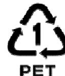
回収されたペットボトルは粉碎等の処理をし、フレーク（小片に粉碎したもの）やペレット（フレークを溶かし粒状にしたもの）にします。その後、フレークやペレットは溶融、成形など原材料化され、繊維製品（フリースなどの衣類品）やシート製品など様々な商品に生まれ変わります。
