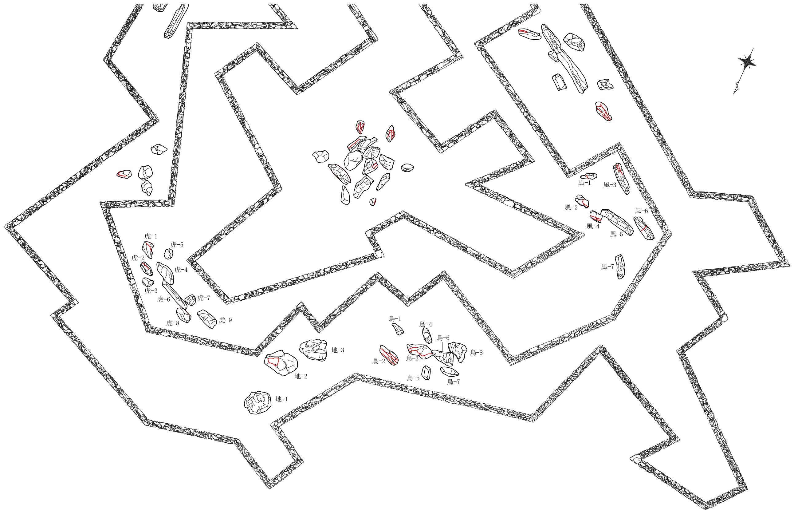
八陣の庭 各陣破損状況 概略図 2
