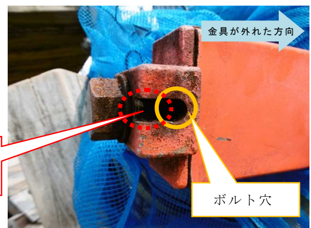
摩耗によりボルト穴が広がり、固定金具が支柱から外れた（反対側も同様の状況）
