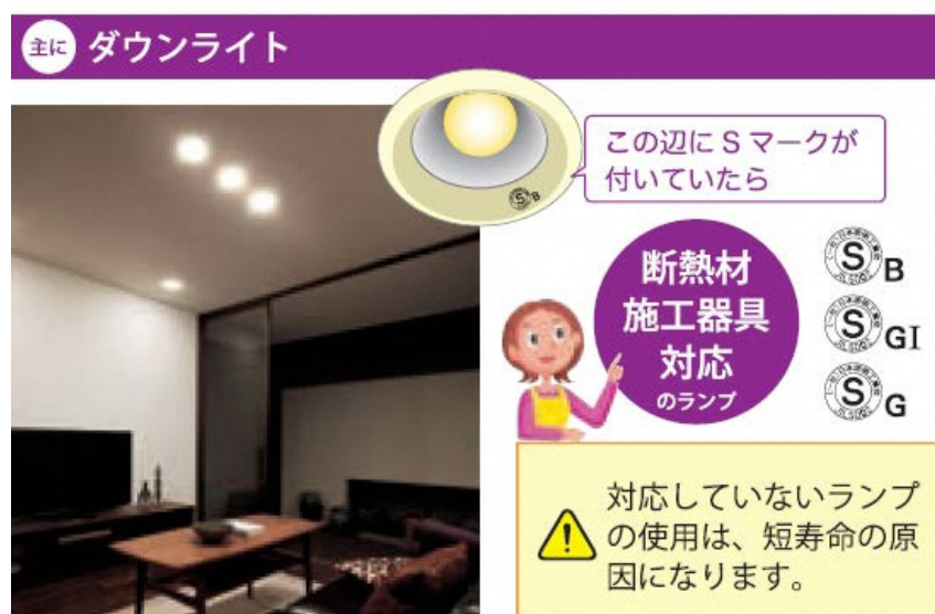
図 7. 断熱材施工器具対応のタイプの例 11
