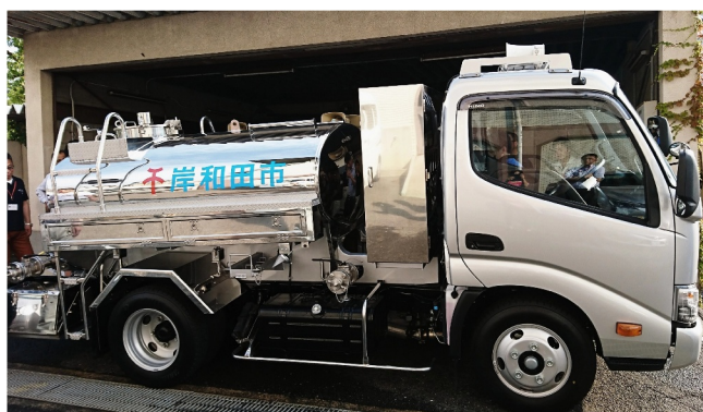
写真：加圧給水車
