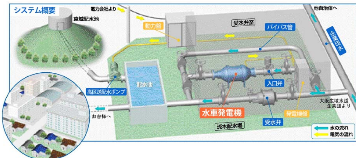
図：流木配水場小水力発電設備概要図
