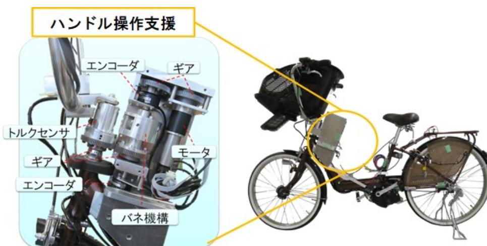
図 117 操作支援システム搭載自転車（東京電機大学提供資料）
