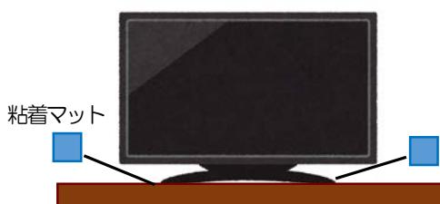
テレビとテレビ台の間に設置するタイプのもので振動を吸収する力により、転倒を防止します。
