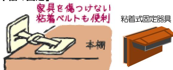
タンスと同じように、壁の中の硬い所があるところにポール式器具を取りつけます。また、壁に穴をあけないタイプの粘着式の固定器具もあります。
