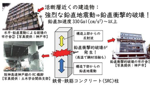
注) 地下10mで330Gal⇒地表面で660Galに増幅し、また、岩盤内地下255mで127Gal⇒地表面で1399Galに増幅が計測された。
