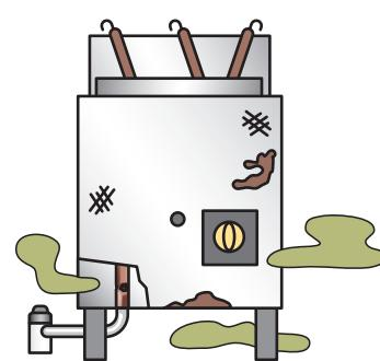
ガス機器が腐食劣化して穴が空いていると、その部分からガスが漏えいします。漏えいしたガスに近くの火が引火して爆発します。
