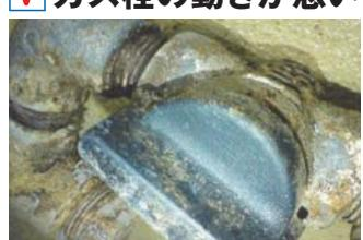
ガス栓や器具栓が劣化すると、すき間からガスが漏えいします。
