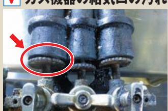
油汚れ等でバーナーの給気口が塞がれ、不完全燃焼を起こします。
